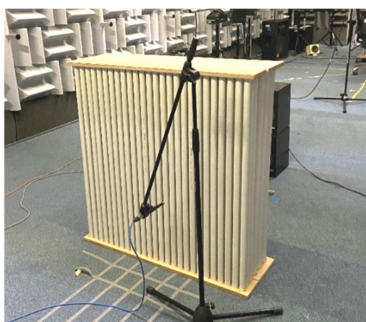
Projekt III.PB.01. Widok i schemat laboratoryjnego stanowiska pomiarowego oraz widok modelu fizycznego bariery akustycznej (A-3)
