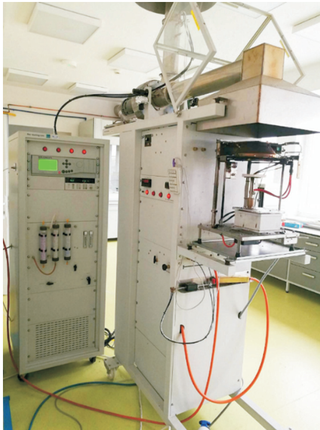
Fot. 1. Zdjęcie poglądowe kalorymetru stożkowego firmy FTT [źródło: materiały własne]
