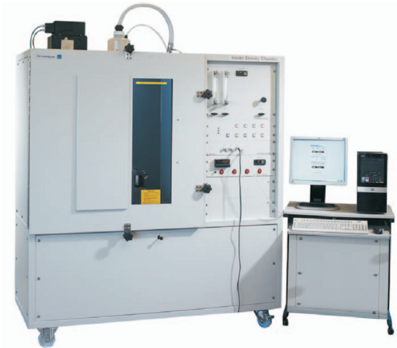
Fot. 3. Komora do badań dymotwórczości [źródło: materiały własne]
