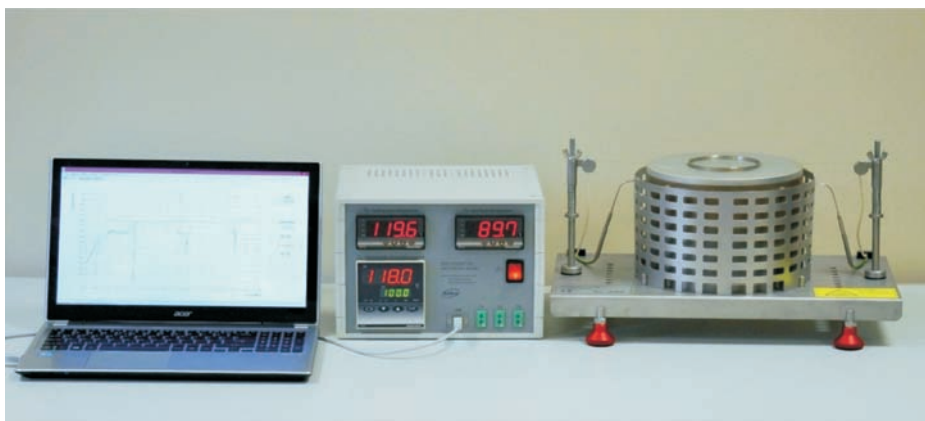
Fot. 4. Przykładowe stanowisko do badania minimalnej temperatury zapłonu warstwy pyłu
