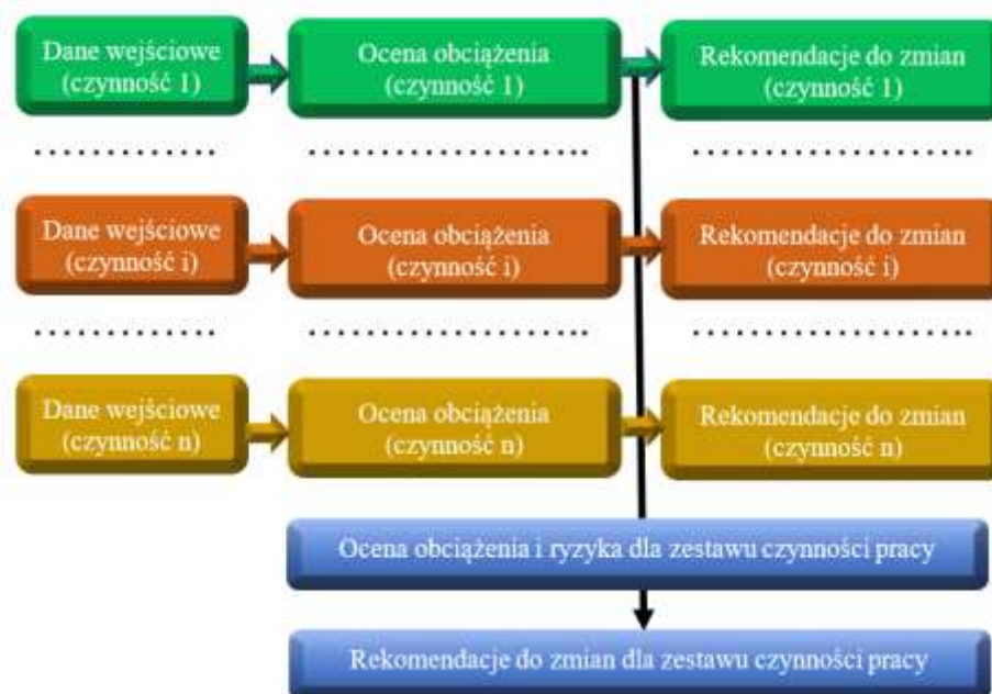
Rys. 10. Wprowadzanie danych wejściowych, ocena obciążenia i rekomendacje do zmian dla modułu UNIWERSALNE STANOWISKO PRACY w programie INTERGON
