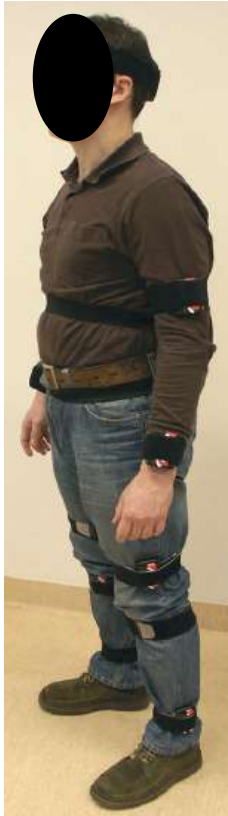
Rys. 24. Miejsca umieszczenia czujników na ciele osoby badanej podczas rejestracji ruchu w programie FAB Recorder
