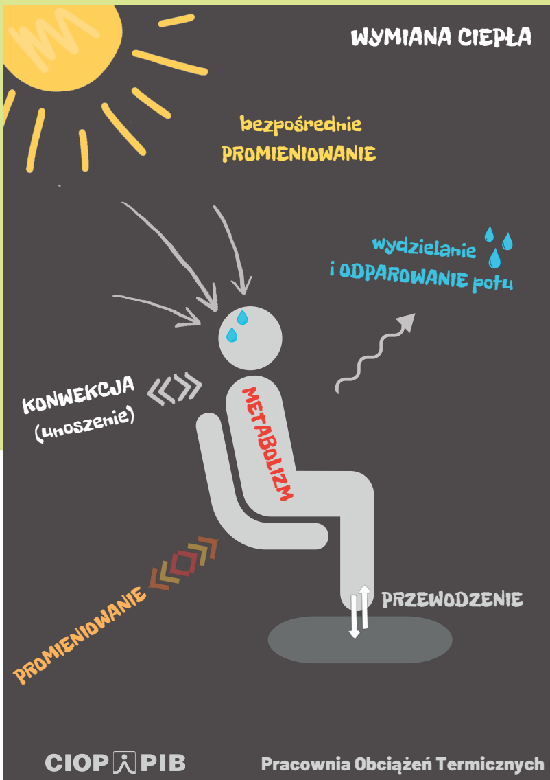
Rys. 2. Drogi wymiany ciepła w układzie człowiek – otoczenie [Pracownia Obciążeń Termicznych FB; https://fb.watch/dNbwgVTxr/ ]
