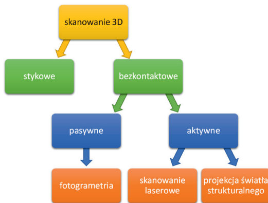
Rys. 6. Uproszczony podział technik skanowania 3D [3]
