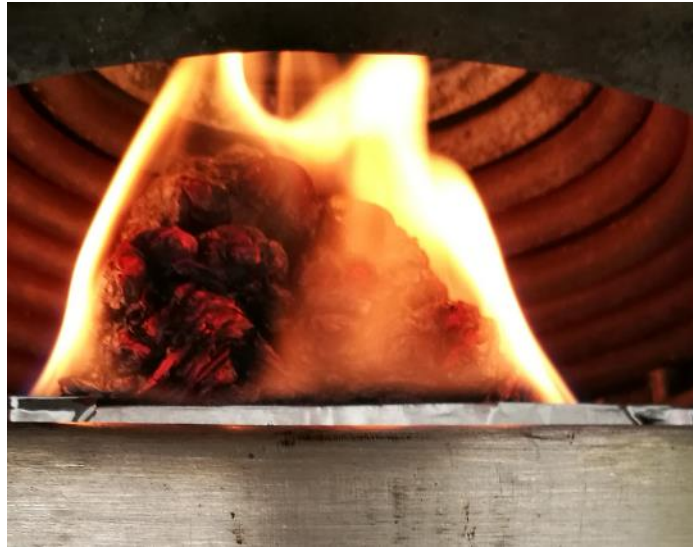
Rys. 12. Warstwa spęcznionej zwęgliny powstająca w trakcie spalania mio-inozytoli [źródło: opracowanie własne]
