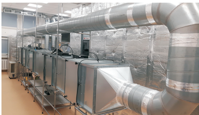
Rys. 1. Stanowisko do badania parametrów filtrów powietrza zgodnie z PN-EN ISO 16890
