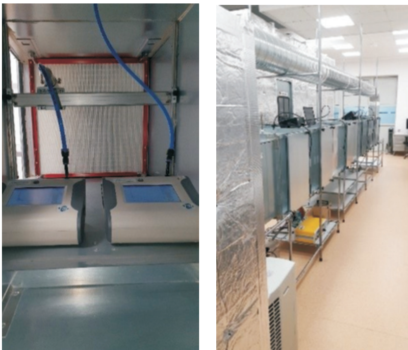
Rys. 2. Stanowisko do badania filtrów powietrza zgodnie z PN-EN 1822 i PN-EN ISO 29643
