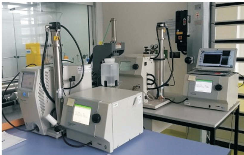
Rys. 4. Stanowisko do badania parametrów filtrów powietrza zgodnie z PN-EN ISO 21083-1
