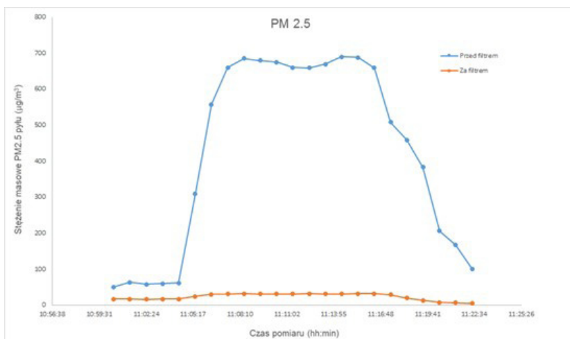
Rys. 6. Zmiany stężenia masowego frakcji PM 2.5 w czasie określonej modelem wskaźnika jakości filtra powietrza
