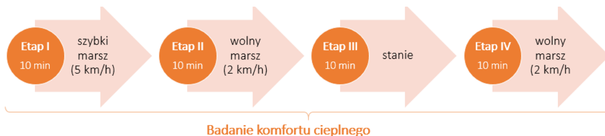
Rys. 8. Schemat przebiegu badania komfortu cieplnego w zestawie odzieżowym z kamizelką ciepłochronną (źródło własne)
