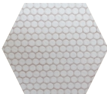
Rys. 1. Fotografia włókniny z mikrokapsułkami PCM zastosowanej w kamizelce ciepłochronnej ( foto. źródło własne )
