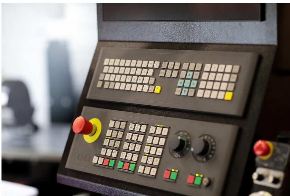
Fot. 2. . Pulpit sterowniczy maszyny, którego obsługa może sprawiać trudności po założeniu rękawic ochronnych
