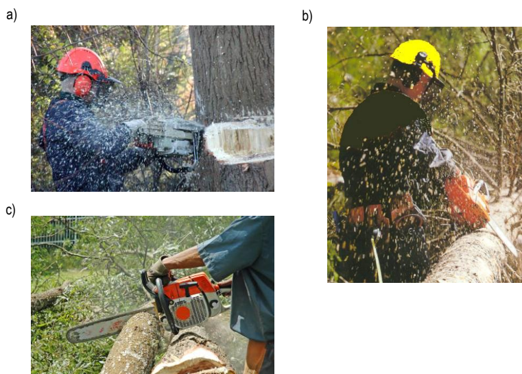
Rys. 3. Podstawowe operacje technologiczne pozyskiwania drewna: a) – ścinka, b) okrzesywanie, c) – przerzynka
