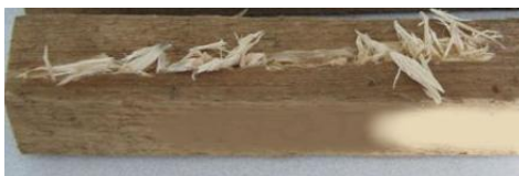
Rys. 25. Rżaz po odbiciu w wilgotnej świerkowej próbce płaskiej
