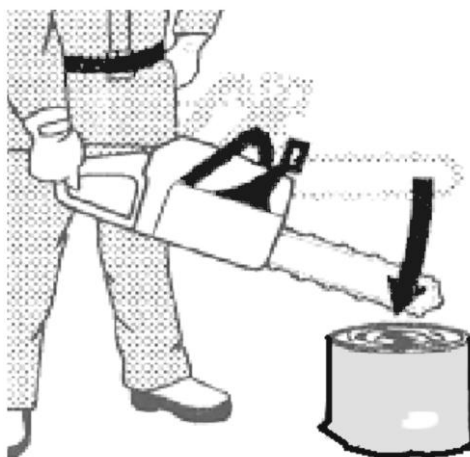
Rys. 19. Sposób bezwładnościowego uruchamiania hamulca pilarki
