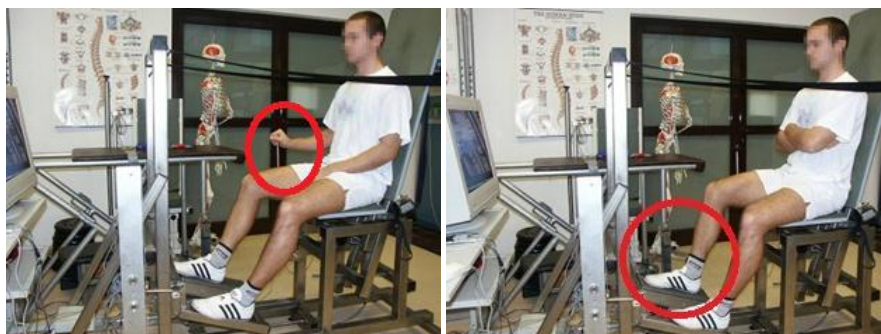
Rys. 2. Stanowisko do pomiaru dokładności sterowania dźwignią (po lewej) i pedałem roboczym (po prawej)
