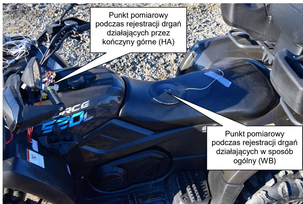
Fot. 1. Lokalizacja punktów pomiarowych podczas badań drgań mechanicznych działających na pracowników/kierowców pojazdów typu ATV
