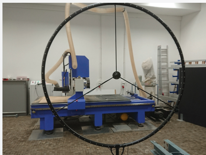
Rys. 9. Widok badanej frezarki CNC i matrycy mikrofonowej kamery akustycznej w punkcie pomiarowym
