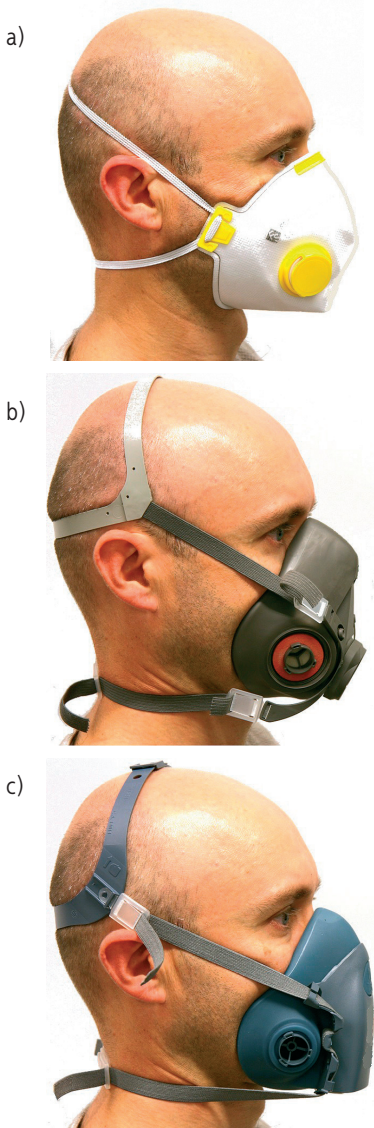
Rys. 8. Półmaska: a) filtrująca, b) przeznaczona do skompletowania z elementami oczyszczającymi z taśmą regulowaną przy części twarzowej, c) przeznaczona do skompletowania z elementami oczyszczającymi z taśmą regulowaną przy elemencie umieszczonym z tyłu głowy użytkownika
