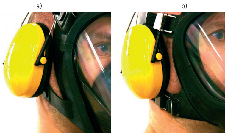
Rys. 12. Czasza nauszników przeciwhałasowych stosowanych jednocześnie z maską: a) odstająca od twarzy, b) przylegająca do twarzy
