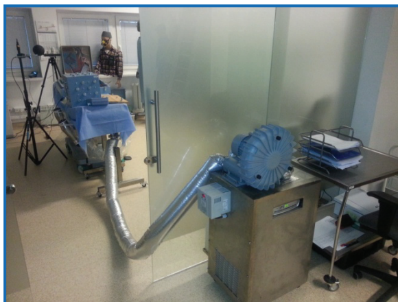
Rys. 1. Widok ogólny urządzenia do indywidualnej wentylacji personelu sal operacyjnych
