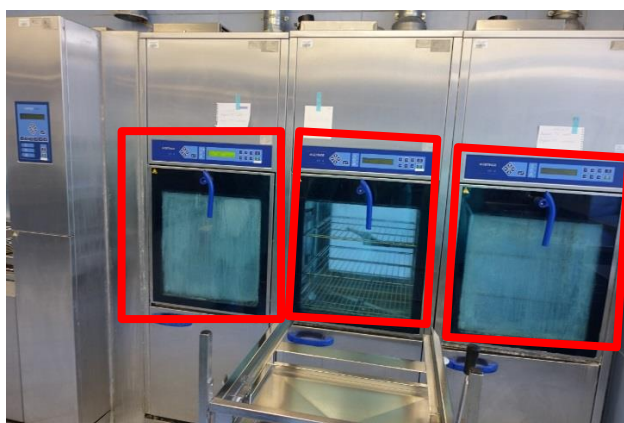
Rys. 5.41. Widok myjek z zaznaczonymi polami zadania (pomiarowymi) w płaszczyźnie pionowej o wymiarach 70 x 54 cm
