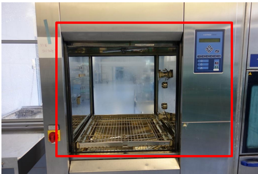
Rys. 5.42. Widok myjki (pierwszej z lewej strony) z zaznaczonym polem zadania (pomiarowym) w płaszczyźnie pionowej o wymiarach 68 x 68 cm
