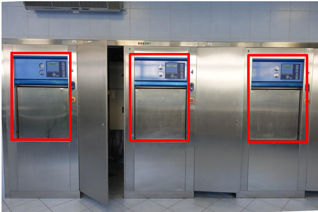
Rys.5.37. Widok trzech autoklawów z zaznaczonymi polami zadania (pomiarowymi) – pulpit sterowniczy i obszar załadunku - w płaszczyźnie pionowej o wymiarach 65 x 65 cm
