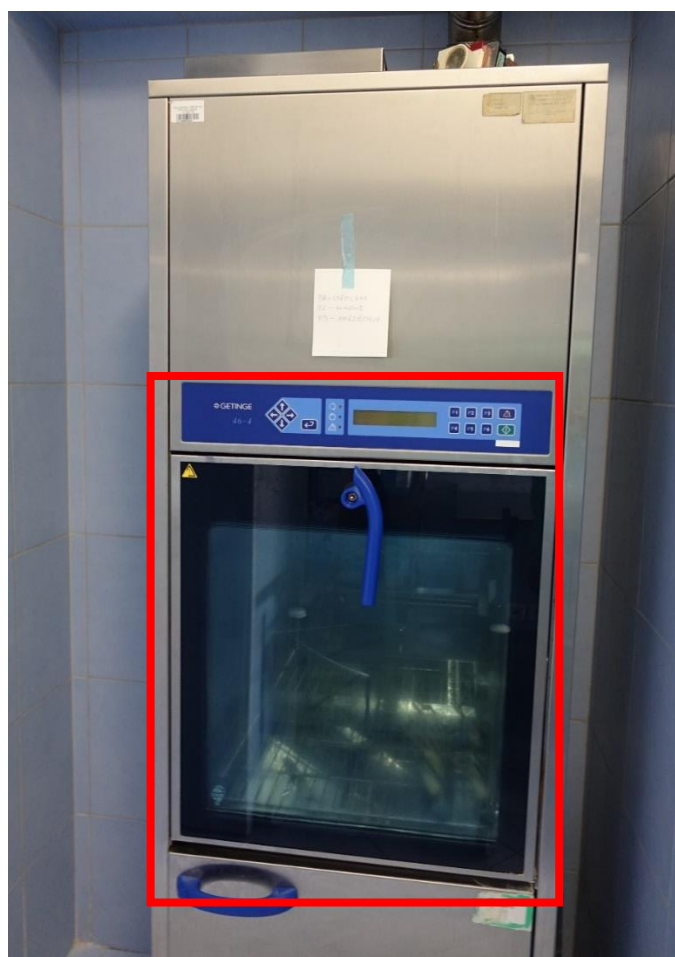
Rys.5.43. Widok myjki chemicznej z zaznaczonym polem zadania (pomiarowym) w płaszczyźnie pionowej o wymiarach 70 x 54 cm
