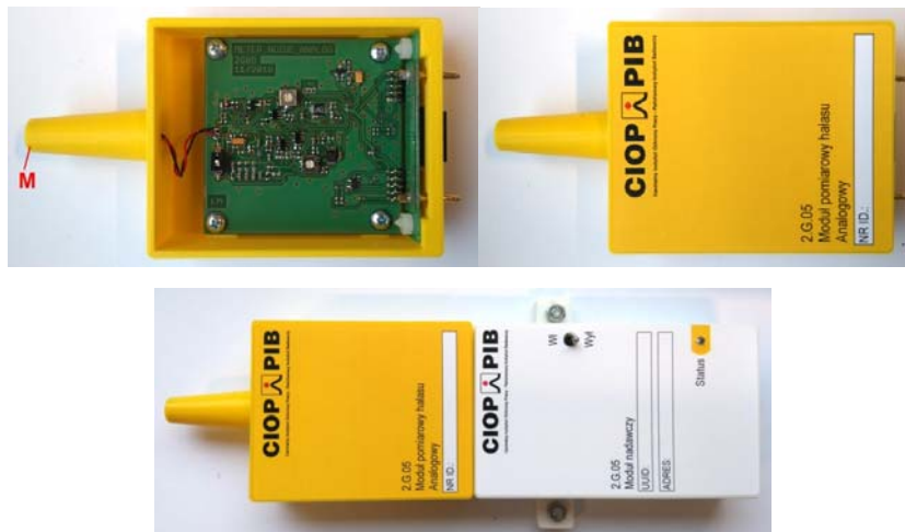
Rys. 4. Moduł sensorowy hałasu (u góry: M – mikrofon) oraz układ pomiarowy hałasu (na dole)
