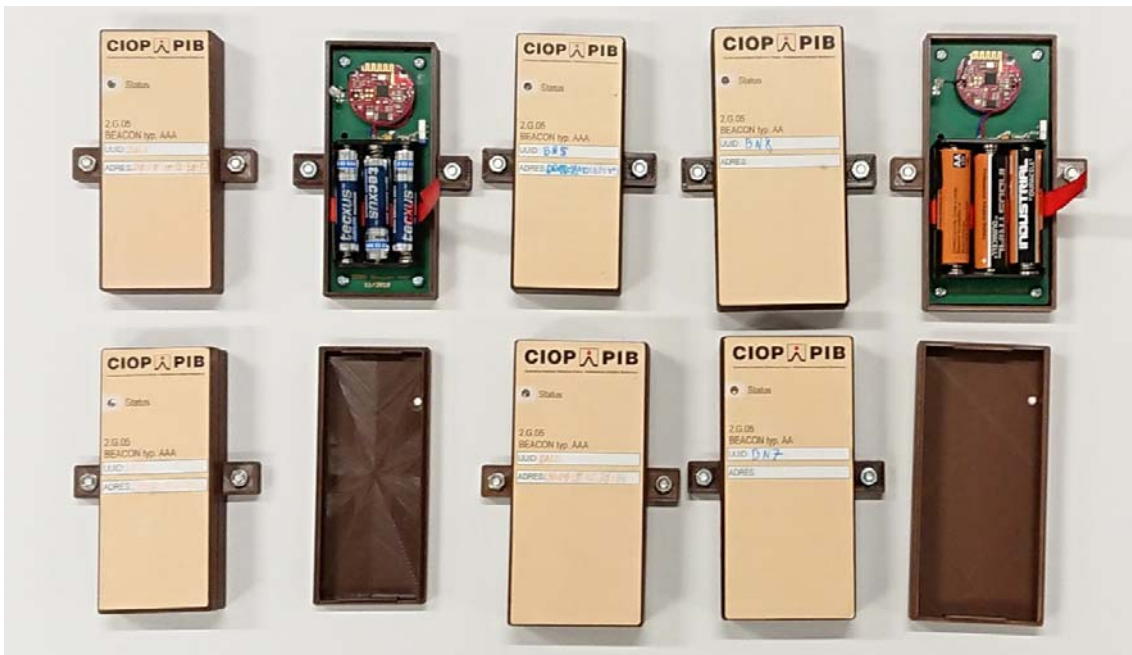
Rys. 6. Beacon i jego konstrukcja wewnętrzna
