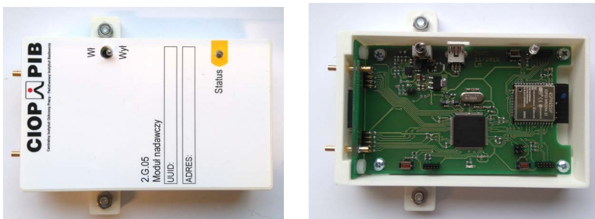
Rys. 3. Moduł nadawczy i jego konstrukcja
