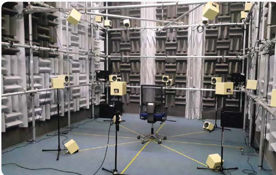
Fot. 3. Stanowisko laboratoryjne do badań percepcji dźwięku i orientacji przestrzennej umożliwiające odtwarzanie dźwięku przestrzennego z wykorzystaniem techniki ambisonicznej Photo 3. Laboratory stand for reproducing spatial sound using ambisonics for research on sound perception and spatial orientation
