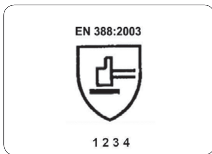
Rys. 2. Znak graficzny informujący o odporności mechanicznej rękawic ochronnych z przykładowym kodem cyfrowym [7]
