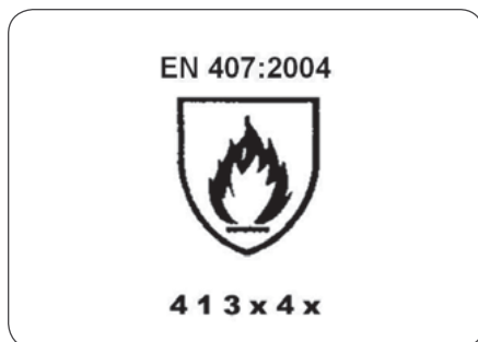
Rys. 3. Znak graficzny informujący o odporności na gorące czynniki termiczne z przykładowym kodem cyfrowym [8]
