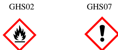
Rys. 1. Kody hasła ostrzegawczego „Niebezpieczeństwo”. Piktogramy określone w rozporządzeniu WE nr 1272/2008 mają czarny symbol na białym tle z czerwonym obramowaniem
